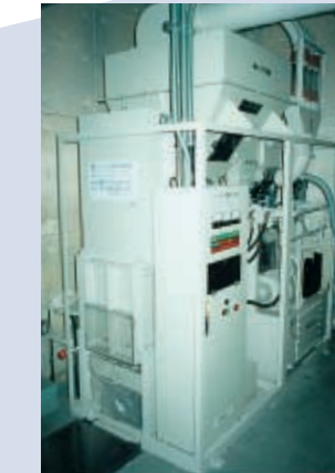
コンパクト型紙片処理装置 分離機・コンパクター・バグフィルターが一体のため、設置場所が非常に小さく、限られたスペースに有効です。
