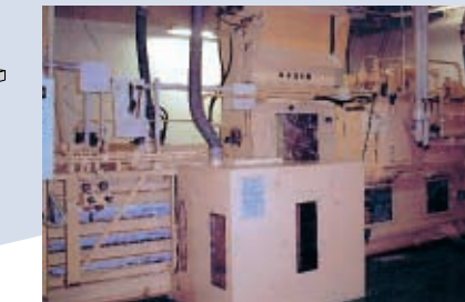
コンパクター 回収物を圧縮してコンパクトなブロック型に成形するため処理が容易になります。
