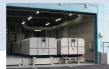
コンテナ装置 大量の処理物を連続的に大型コンテナに圧縮投入し、満杯になったコンテナはフックローラーにより搬送処理されます。
